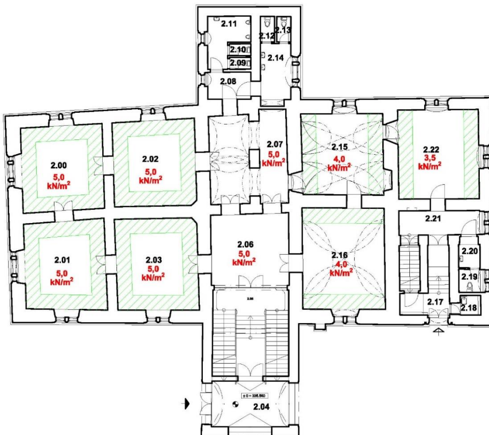
obr.16 zaťažiteľnosť 1.NP (prízemia) s vyznačením plôch s jej možným zvýšením
