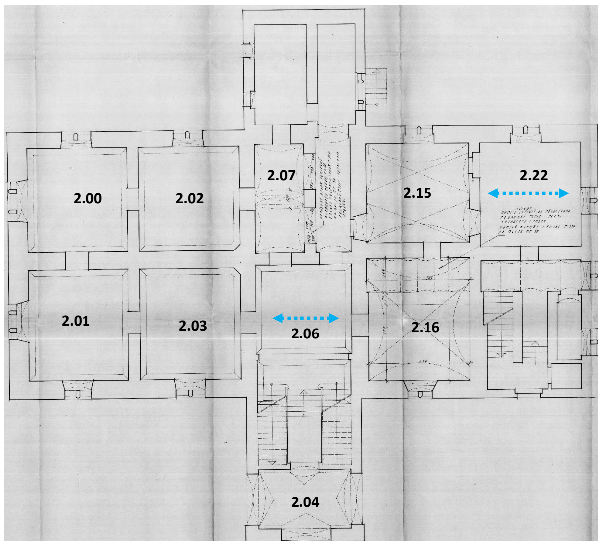
obr.07 výkres tvaru stropu nad 1.NP (zdroj [2])
